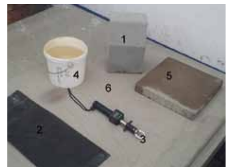
3. Stanowisko do badań szacowania odporności na poślizg nawierzchni betonowej
