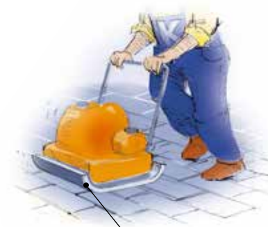
okładzina PCV chroniąca kostkę przed uszkodzeniami
