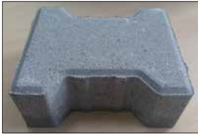
Fot. 3 | Kostka fazowana z niewielką wypływką
