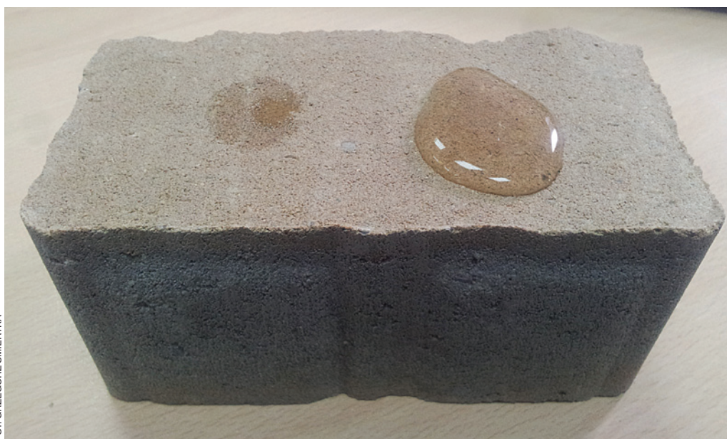
Fot. 2. Test odporności powierzchni betonowej
